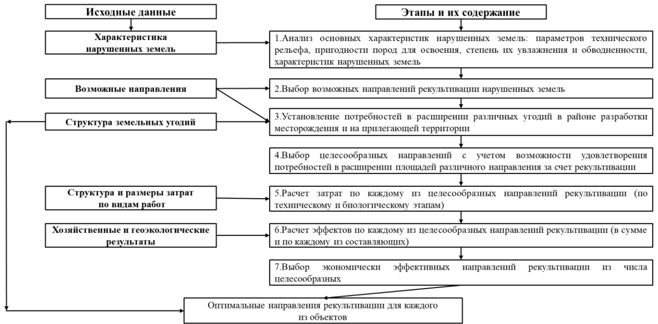
Рисунок 2.4 – Укрупненная схема алгоритма поиска оптимального направления рекультивации
