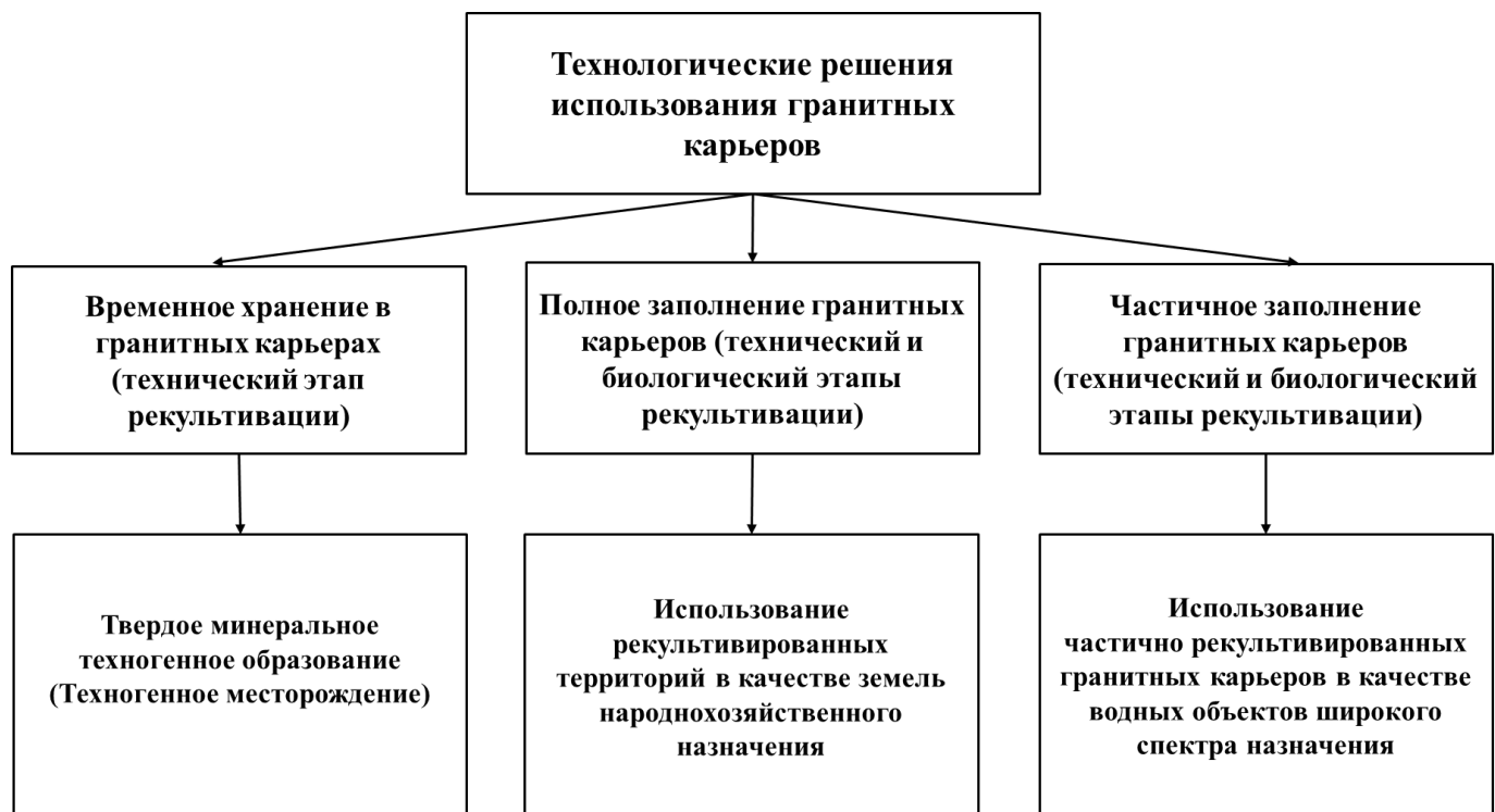
Рисунок 2.1 – Технологические решения использования гранитных карьеров
